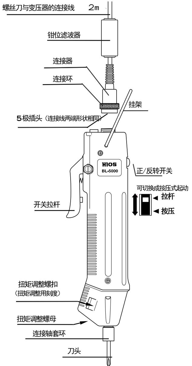
电动螺丝刀的连接器仅能使用苏州中日兴通讯有限公司生产的5P连接器
