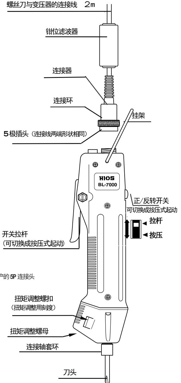
电动螺丝刀的连接器
