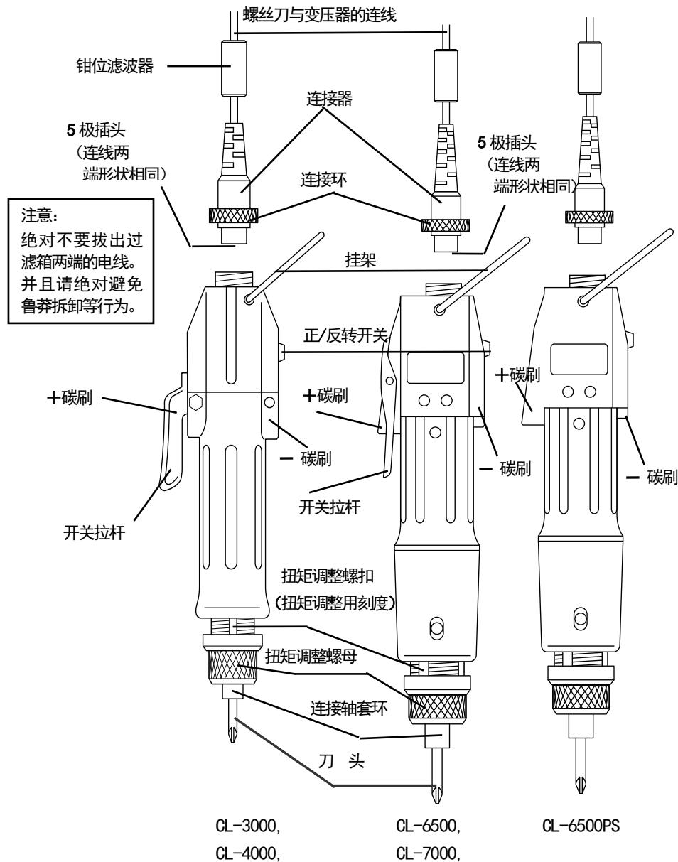
电螺丝刀的连接器仅能使用苏州中日兴通讯有限公司生产的 5P 连接头（型号 NS-1605-02 RG）
