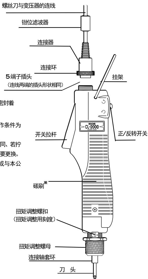
电动螺丝刀的连接器仅能使用苏州中兴通讯有限公司生产的 5P 连接头（型号 NS-1605-02 RG）
