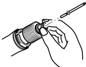
②放开连接轴轴环，确认刀头被锁定。
