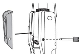
取り外したスイッチレバーを裏側にセットして、再度六角ヘッドスクリューで固定する
