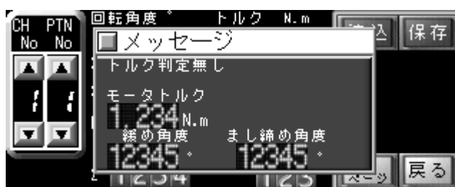
图 12-13 信息提示窗口_扭力判定 NG、再次锁紧角度判定与拧松角度判定 OK (模式 4)
