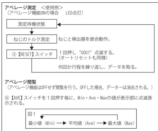
※ アベレージ測定に入る前に、必ず【MODE】スイッチを PEAK か F.PEAK にセットして下さい。アベレージ測定 ON の時は【MODE】スイッチ、【UNIT】スイッチは効かなくなります。
