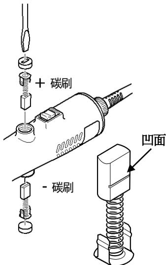
由于磨掉的碳粉会造成绝缘功能的降低，建议使用 100 万次后，或者使用 1 年后将电动螺丝刀交给厂家或经销商做检查及维护。
