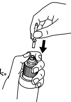
VZ-1820, VZ-1820PS, VZ-3012, VZ-3012PS 电动螺丝刀的一个特征是可以兼用 HIOS 的  $\phi 5$  的刀头和市场上有售的一般六角形对边距 5.0mm 的刀头。
