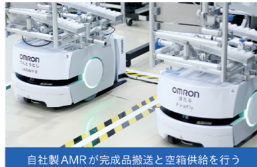
自社製AMRが完成品搬送と空箱供給を行う
