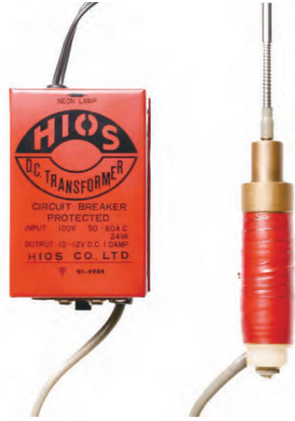
世界初となる産業用電動ドライバーM型
