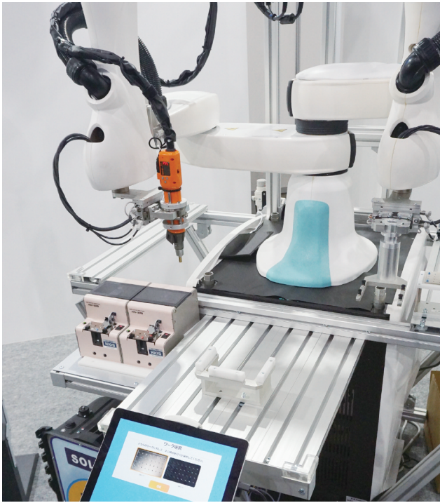
小型協働ロボットによる締結システム
