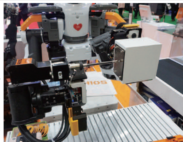
NEXTAGEのシステムによる横締め(THK)
