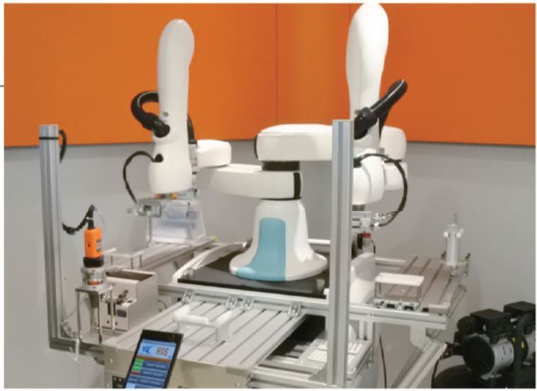
電動ドライバーと協働ロボットを組み合わせたねじ締め自動化提案
